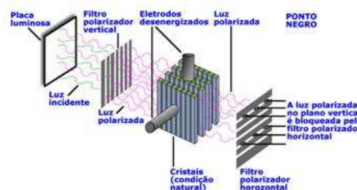
Figura 32: Esquema de uma tela de cristal líquido Fonte: NUNES, 2009.
