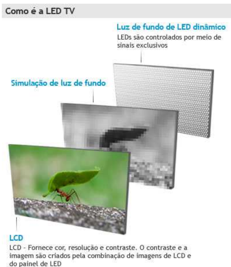
Figura 34: Partes de uma TV de LED Fonte: NUNES, 2009
