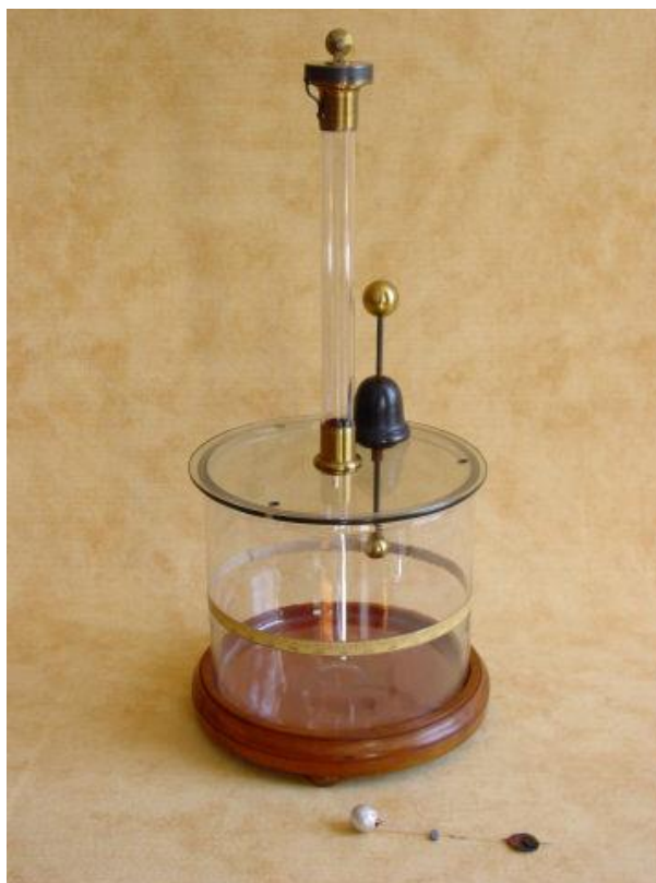
Figura 5 – Balança de torção – O ENGENHO e a Arte, Coleção de Instrumentos do Real Gabinete de Física da Universidade de Coimbra;
