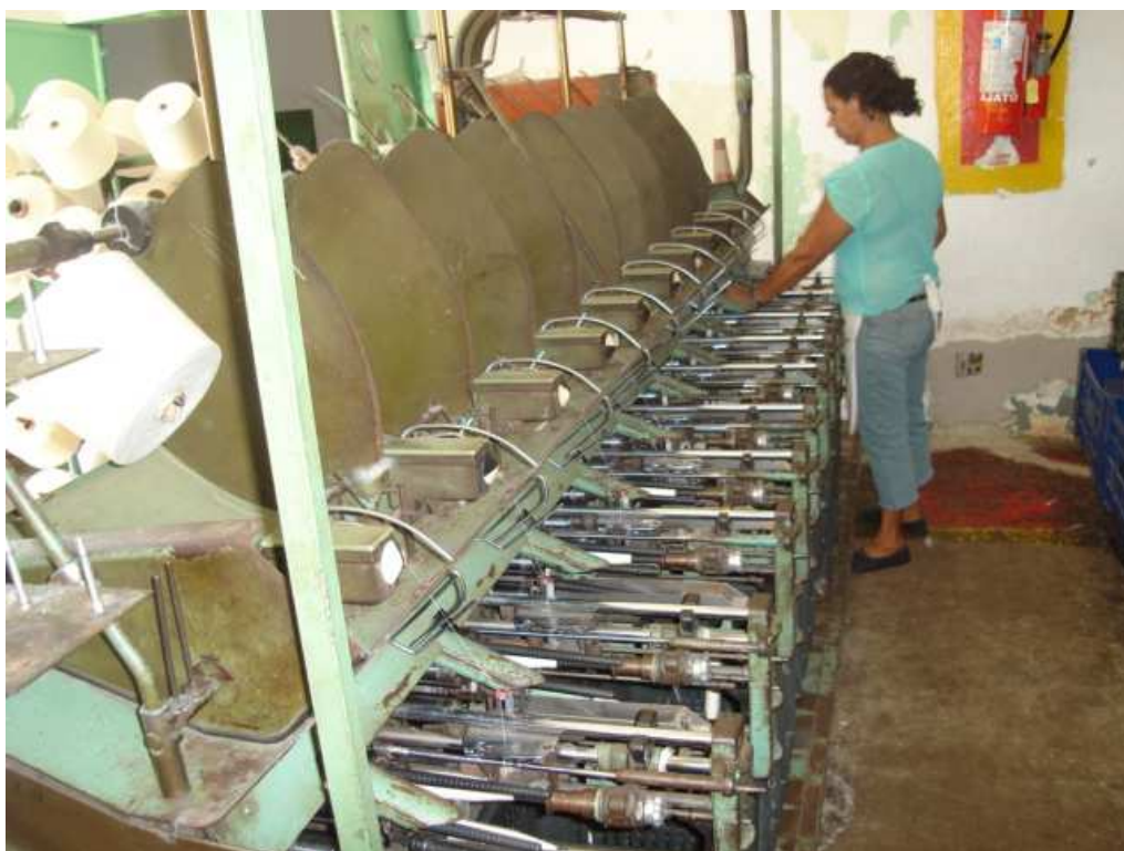
Espuladeiras (Legenda 34000) Faz a passagem dos fios das bobinas para pavios que serão utilizados em outros processos produtivos. Fonte: acervo pessoal
