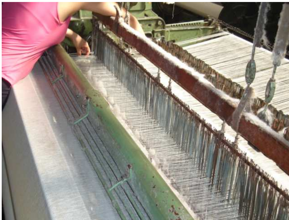
Teares Howa (equipados com o sistema de lançadeiras) (Legenda 36000) Tecerã fazendo a emenda do fio da trama. Fonte: acervo pessoal
