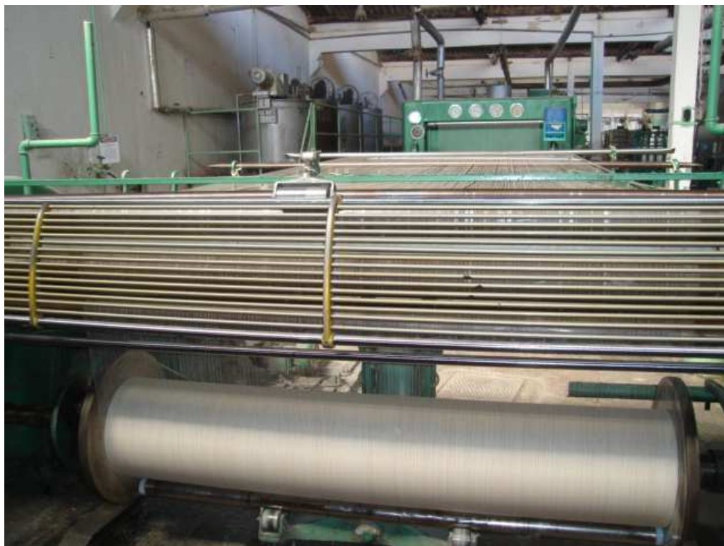
Fios sendo engomados e rolo que será encaminhado à Tecelagem. Fonte: acervo pessoal
