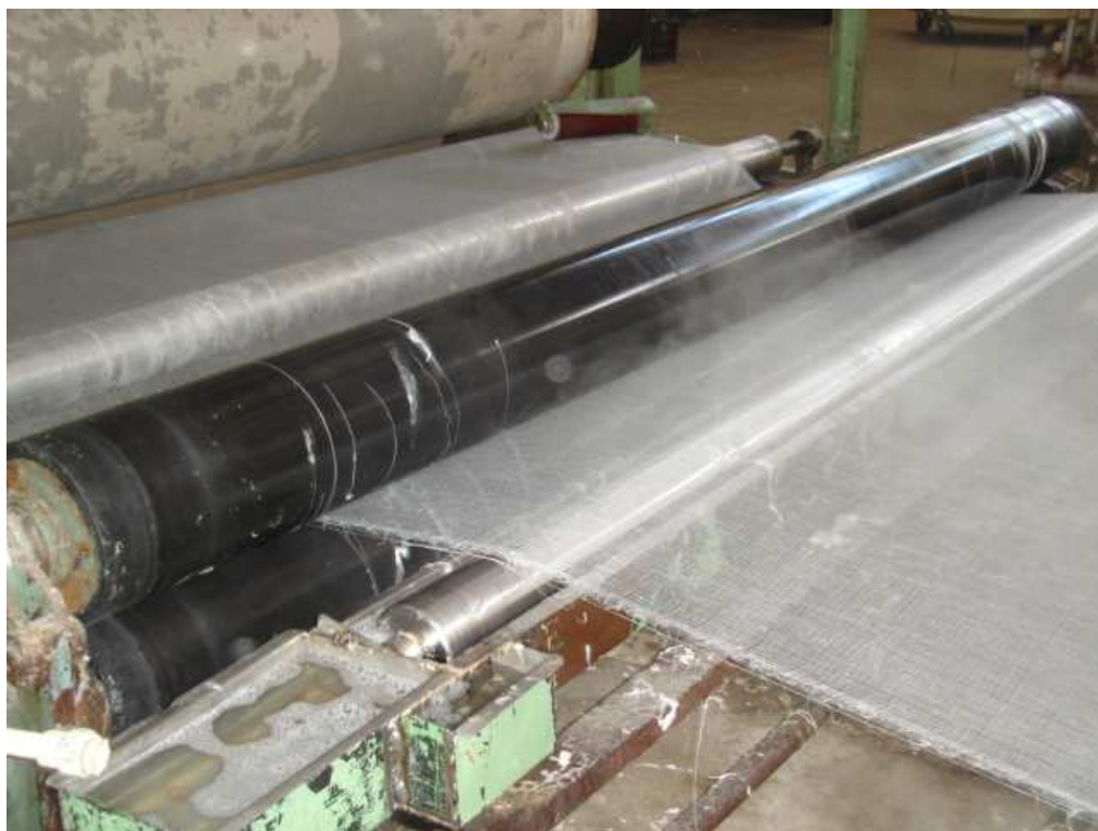
Secadeiras (Legenda 43000) Podes-se ver o excesso de água sendo retirado do tecido (analisar canto inferior esquerdo). Fonte: acervo pessoal
